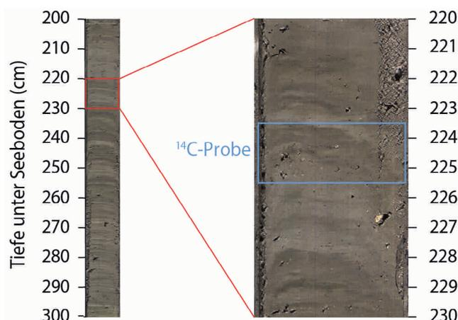
Abb. 9. Fotografie eines Teils (200–300 cm Tiefe) des aufgeschnittenen Sedimentkerns BO19\_32 mit Ausschnitt der Lage der Radiokarbon-Probenahme in 223.5–225.5 cm Tiefe. Die beprobte Schicht aus dieser Tiefe korreliert gegen das Ufer mit der Haldenkante, die sich in den seeseitigen Fuss des Hügels 5 verlängert. Grafik Institut für Geologie der Universität Bern, Dominic Perler.
