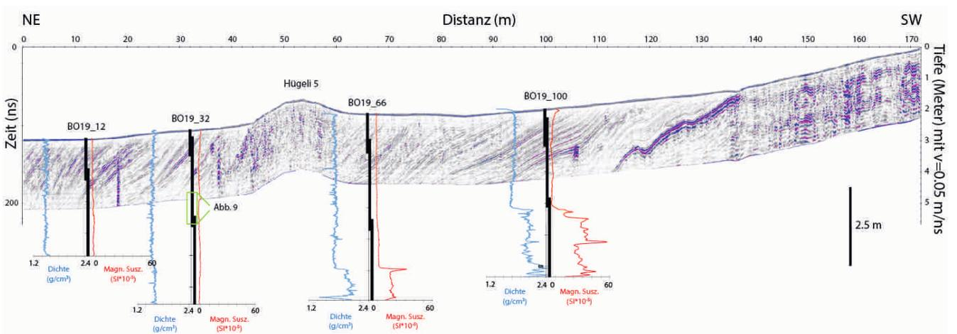
Abb. 8. Utwil TG, Hügel 5. Lage der vier entnommenen Sedimentkerne entlang der Georadar messung durch Hügel 5. Neben dem Kern sind die Bulk-dichte und magnetische Suszeptibilität aufgezeichnet. Radarprofil vertikale Überhöhung x6: Technische Universität Darmstadt, Jens Hornung; Grafik Institut für Geologie der Universität Bern, Dominic Perler und Flavio Anselmetti.
